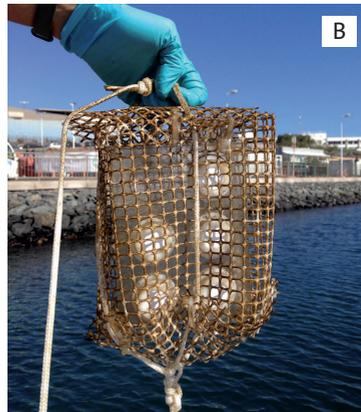
Immagine 7. Crescita del biofilm sull'assemblaggio di DGT a Taliarte (Gran Canaria): (A) Prima della deposizione e (B) Dopo 7 giorni di esposizione (Fonte: ITC).
