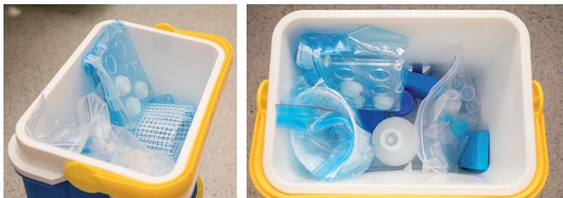
Image 5. Ensemble DGT placés dans un double sac et stockés avec le reste du matériel nécessaire dans une glacière avec blocs réfrigérants (Source : ITC)
